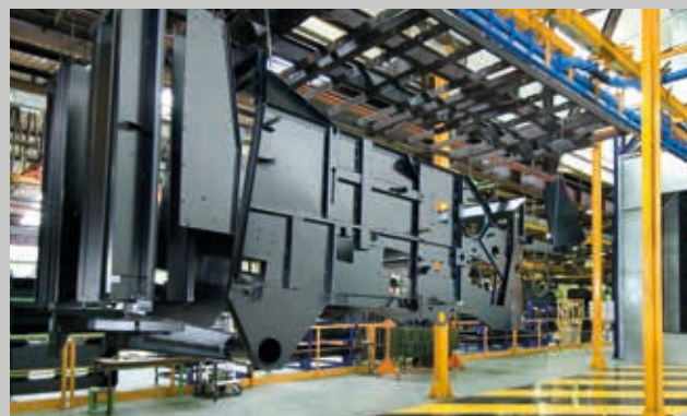
Все компоненты обработаны катафорезом и автомобильной покраской.
