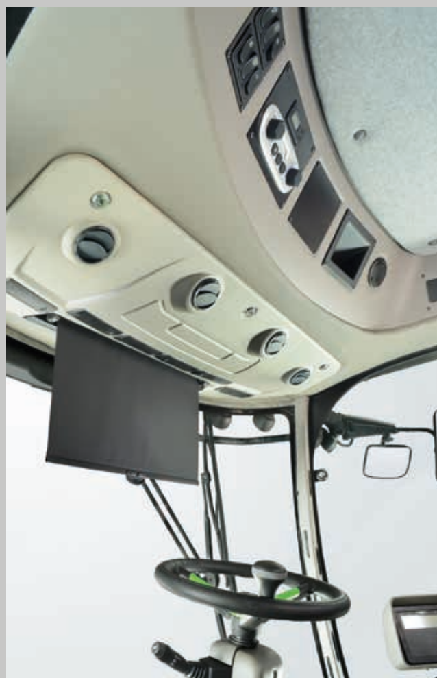
Инновационная система вентиляции с высокоэффективным кондиционированием воздуха и самоблокирующимся солнцезащитным козырьком.
