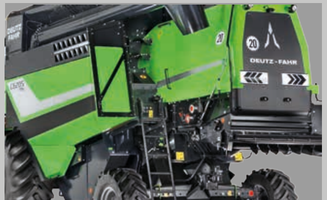
Легкий доступ к верхней части комбайна, а также для заправки дизельного топлива.
