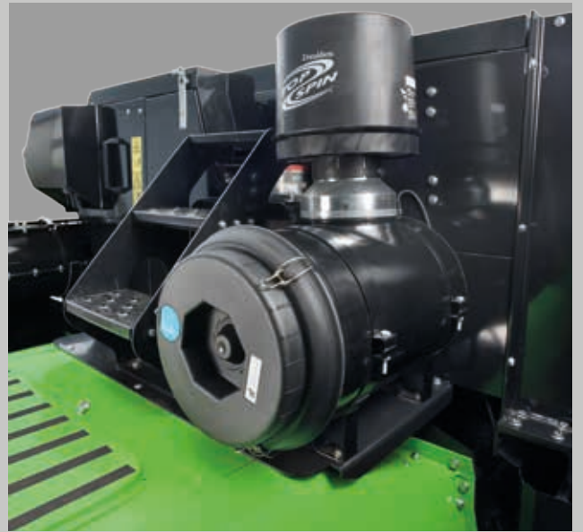
Высокоэффективный самоочищающийся воздушный фильтр для работы в любых условиях.
