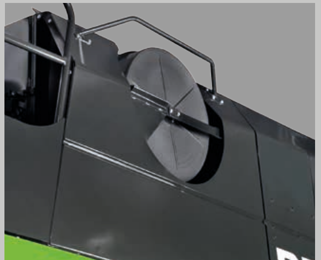
Большой поворотный экран для обеспечения максимальной эффективности системы охлаждения.
